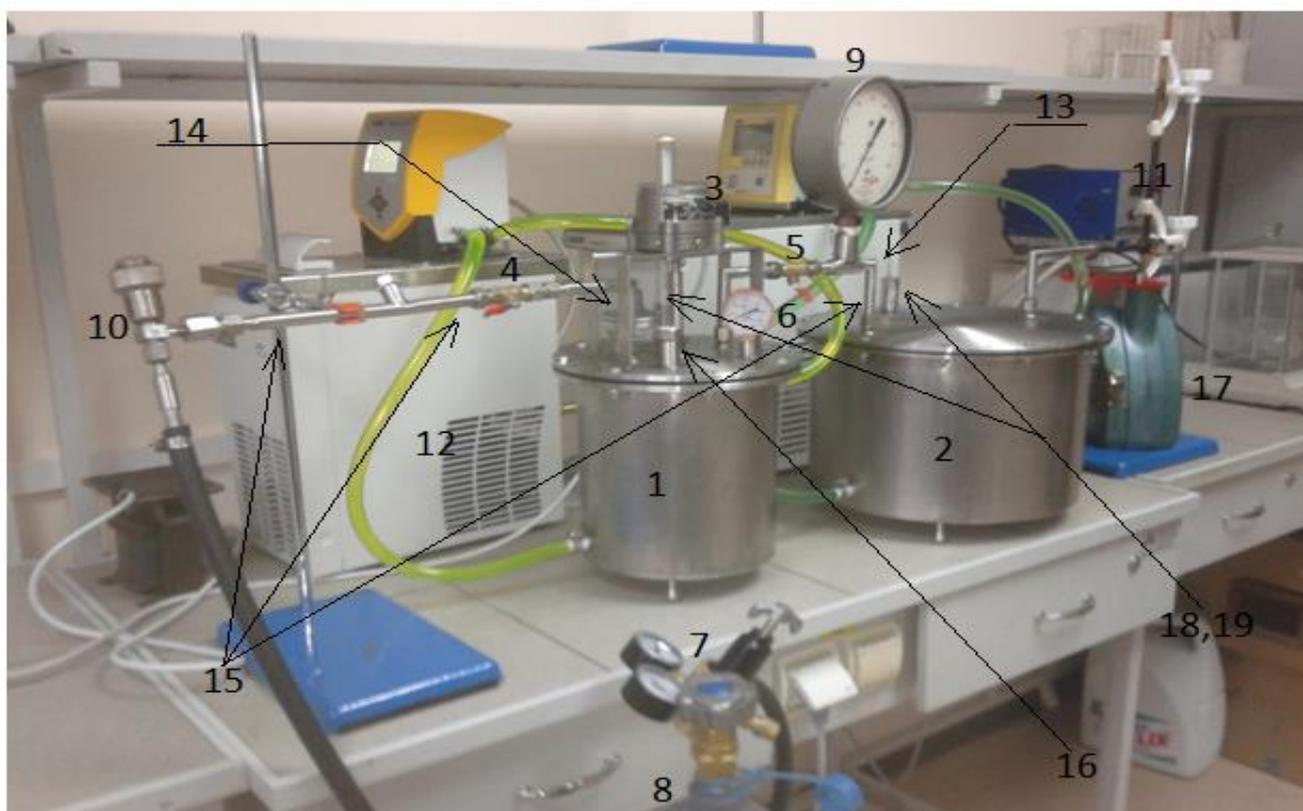
1.термостатируемый резервуар для подготовки нефти. 2. термостатируемый резервуар со змеевиком 3. электрическая мешалка 4,5. шаровые краны 6. манометр 7. Редуктор 8. баллон с инертным газом 9. измерительный манометр, 10. вентиль тонкой регулировки давления. 11.измерительная бюретка 12. нагревательный термостаты 13. охлаждающий термостат 14. предохранительный клапан 15. соединительные трубки 16. патрубок ввода пробы. 17.емкость для слива 18,19 термометры.
