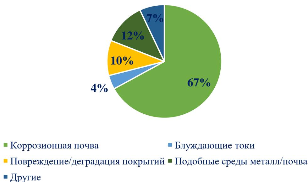
Рисунок 1 – Динамика причин появления коррозии на металлических трубах
