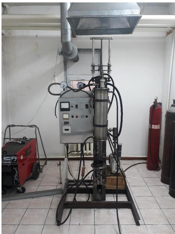
Рисунок 14 – Экспериментальная установка для синтеза фуллеренов
